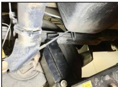
**STEP 4:** Remove lower shock bolt.
